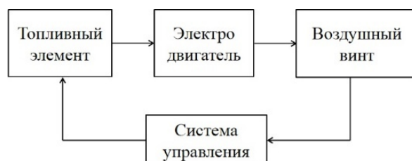
Рис. 1. Схема силовой установки БПЛА
